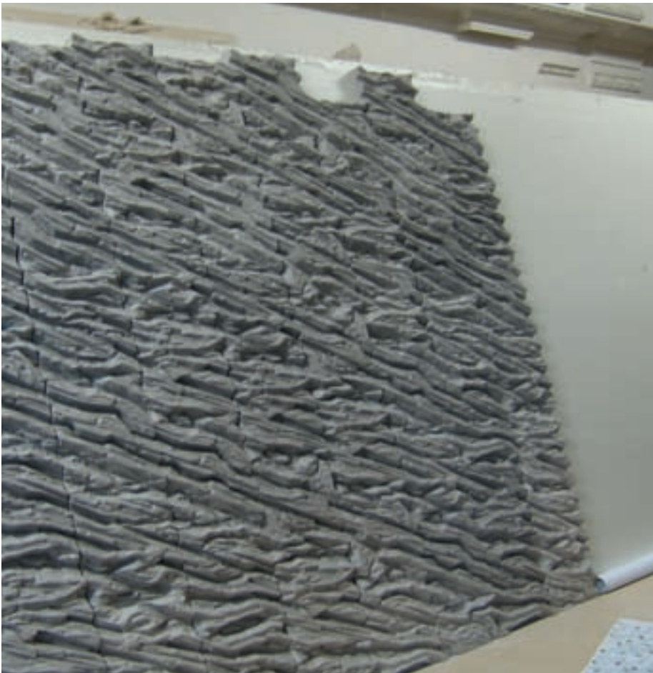
Assemblage de 70 maquettes en plâtre (1/10) Assemblage of 70 plaster samples (1/10) Zusammenfügen von 70 Gipsmodellen (1/10)
