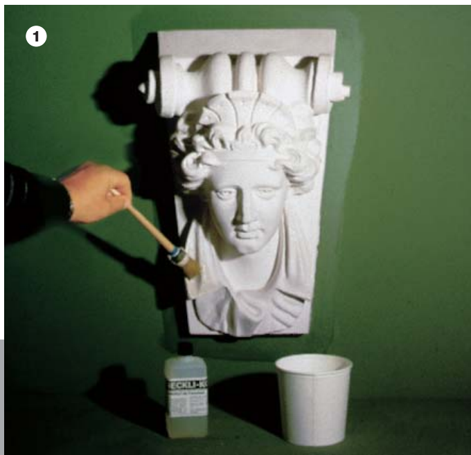
RECKLI-SI-Trennlack mit einem weichen Pinsel aufstreichen Apply RECKLI SI Stripping varnish with a soft brush Application de la Laque de protection RECKLI-SI
