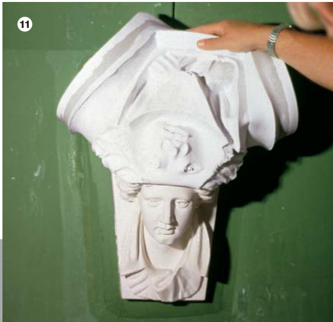
11 Elastische Silikonkautschukmatrize vorsichtig abziehen Carefully peel off elastic silicone rubber matrix Démoulage de la matrice élastique
