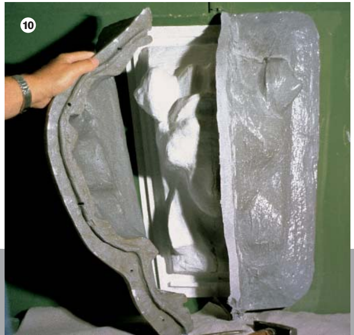
10 2-teilige Stützform mit angeformtem Führungsprofil abnehmen Remove 2-piece supporting mould with guiding profile Séparation et extraction des demi-coquilles
