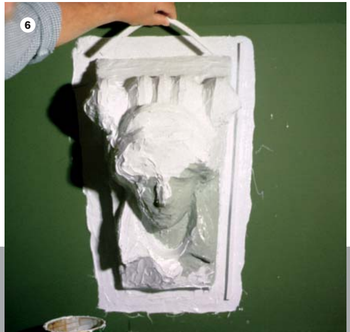
6 Fixierungsstreifen in die zweite Spachtelung einbetten und anformen Embed and adjust fixing strip in second trowelling Mise en place des profils de positionnement
