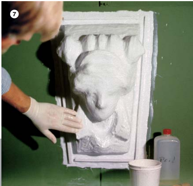
7 Unterschneidungen, Grate und Kanten konisch bearbeiten und glätten Bevel and smooth undercuts, fins and edges Egalisation, suppression des contredépouilles
