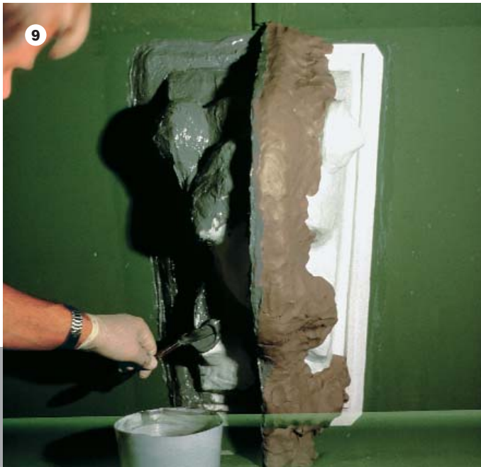
9 RECKLI-Epoxy-GF Spachtel als Stützform aufspachteln Apply supporting mould of RECKLI-Epoxy-GF Filler by trowel Confection du support en Masticoque RECKLI Epoxy-GF
