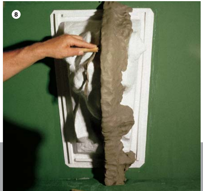
8 Absperren für die 2-teilige Stützform aufkitten und Führungsprofilierungen einschneiden Cement shut offs for 2-piece support mould and cut guiding profiles Bande d'arrêt, découpe des guides d'assemblage
